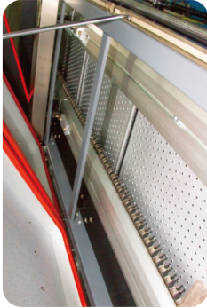
熱風預熱 Hot Air preheat
